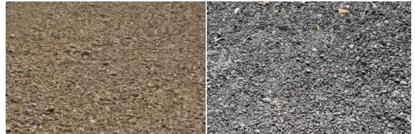
Photographie 192 : Texture des pistes en concassé calcaire / granit.
